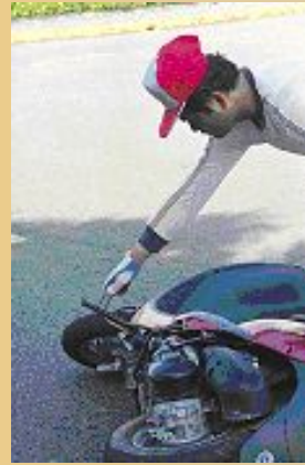
(2) 放出側腳架：扶起時，可直接利用側腳架架車，安全又方便。
