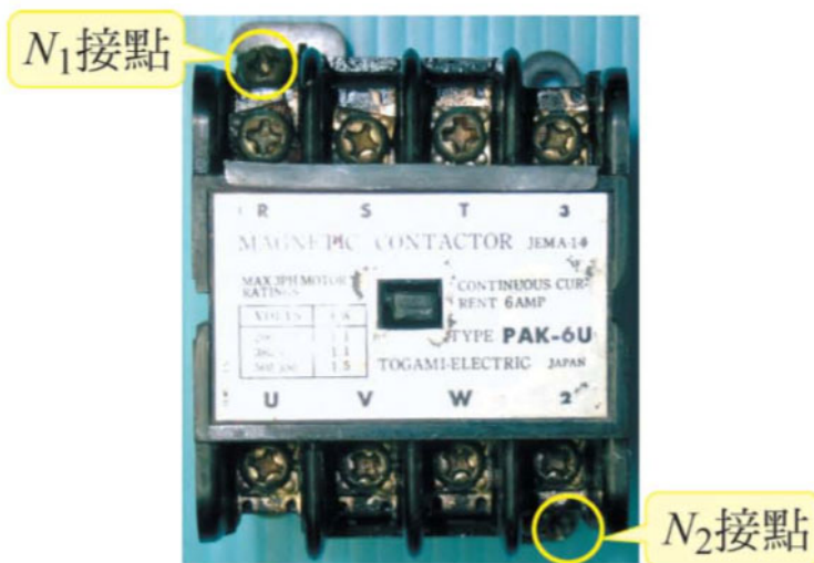
(b) 電磁接觸器構造圖
